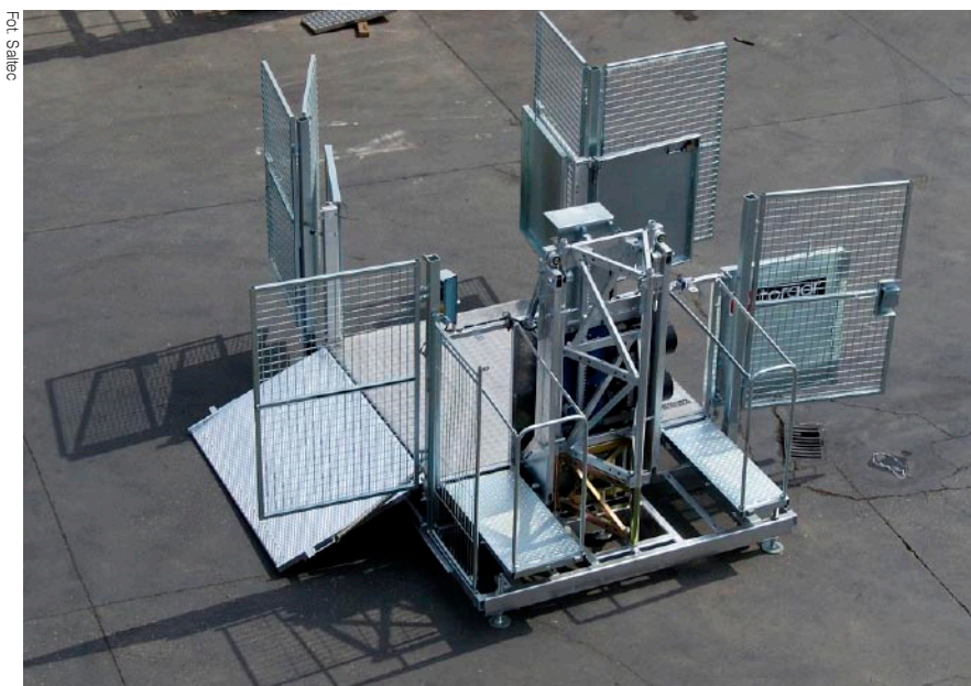
Kabina windy Torgar T3-15 standardowo wyposażona w dwie furty, rampę oraz podesty montażowe
