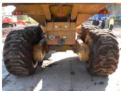
Widok z tyłu. Dobrze widoczne opony o szerokości 850 mm oraz obudowany mechanizm napędowy kół tylnych
